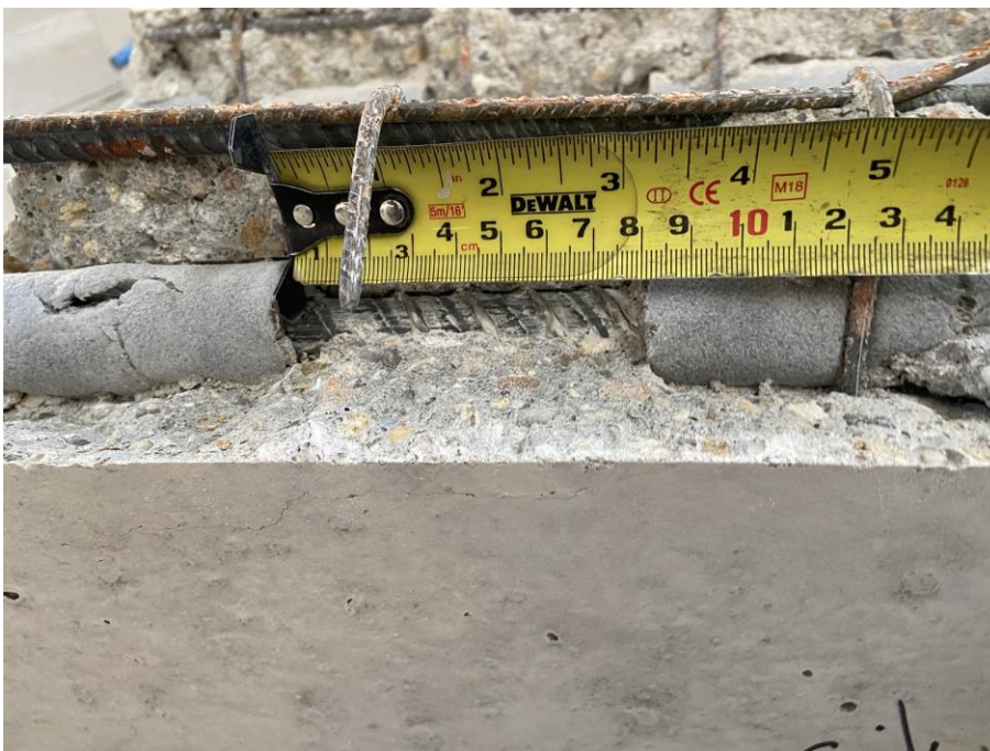
Obr. 3: Vzorka B.T 1.3 – odmeraná dĺžka zakotvenia výstuže
