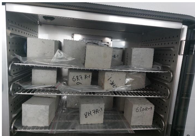
Obr. 2: Vzorky uložené v CO 2 komore
