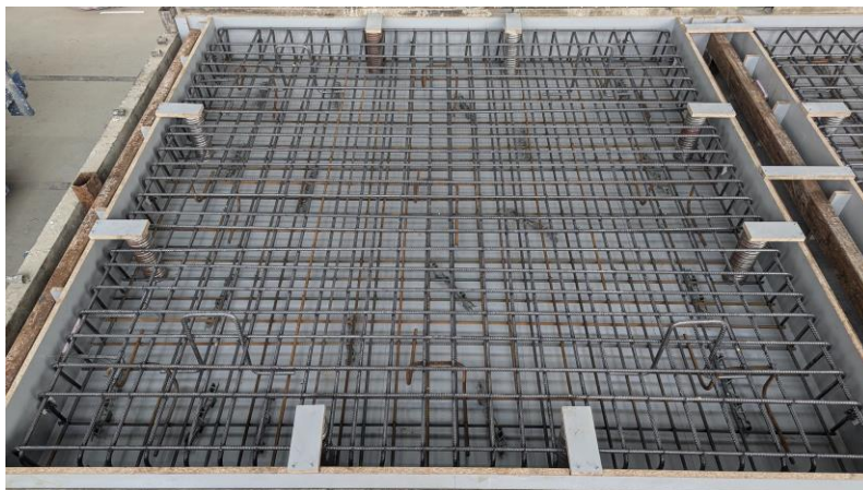
Obr. 2: Vystuženie skúšobných dosiek
