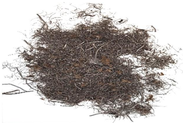
Obr. 1 Recyklované oceľové vlákna z odpadových pneumatík
