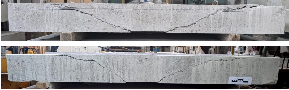
Obr. 4: Porušené a prerezané dosky D1.1 (hore) a D1.2 (dole)
