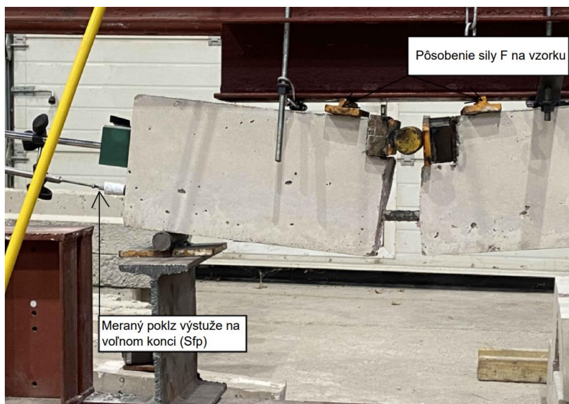
Obr. 2: Znázornenie vytiahnutia vzorky na voľnom konci
