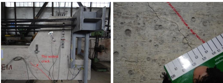
Obr. 20 Experimentálna konštrukcia so snímačmi Obr. 21 Šírka trhliny pri zaťažení 658 kN
