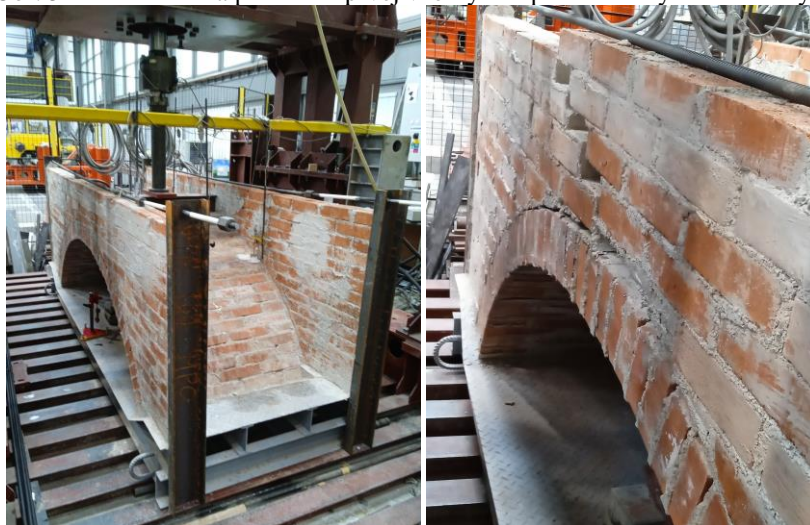
Obr. 6 Zaťažovanie a porušenie druhej vzorky z experimentálnych murovaných klenieb
