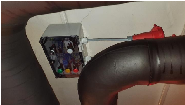
Obr. 3: Monitorovacie zariadenie zrýchlení s napojením na spínač pre napojenie fréz
