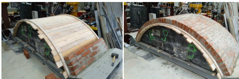
Obr. 3 Príprava tretej vzorky z experimentálnych murovaných klenieb
